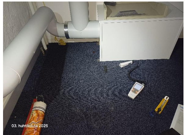
Kuva 26. Viiltomittaus tekstiilipalamaton alta.
