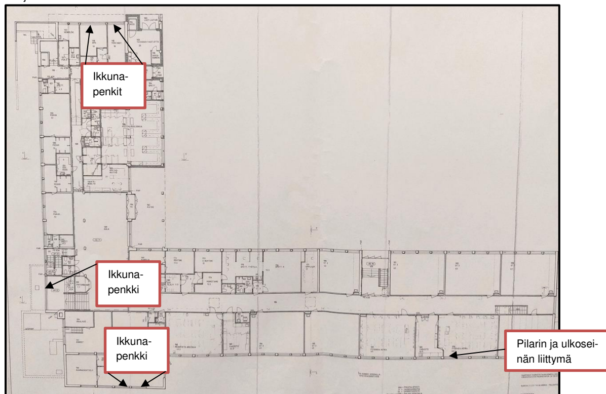
Pohjakuva 10. Havaitut ilmavuodot
