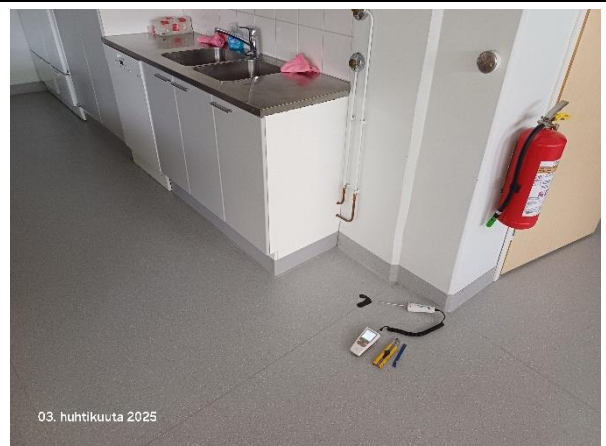
Kuva 28. Viiltomittaus kotitalousluokan pinnoitteena olevan muovimaton alta.
